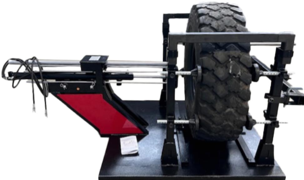
El equipo ofrece **alta precisión y control de las operaciones**, gracias a sistemas de manipulación diseñados para operar de forma progresiva y controlada, permitiendo al operador gestionar cada fase del trabajo con precisión y seguridad. Las soluciones técnicas adoptadas permiten mantener un control constante durante la extracción del sistema run-flat, reduciendo el riesgo de daños en el neumático y los componentes internos.
